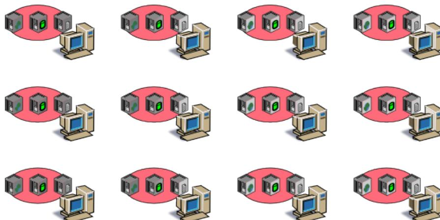
Esquema de un aula de la segunda época en la que los alumnos ejecutan máquinas virtuales en sus equipos.
